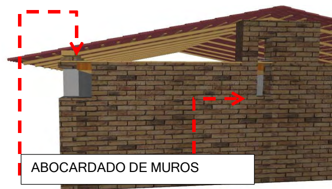
RENDER PROPUESTA 12: Vista exterior de Abocardado de muros para alojar armado de acero, que era el espolón (QUIÑONES MONTES DE OCA (2018))
