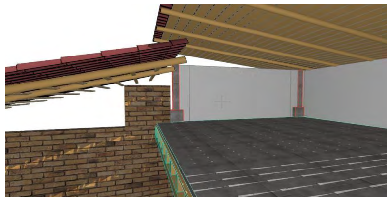
RENDER PROPUESTA 17: Armado de elementos en cubierta, con los elementos originales (QUIÑONES MONTES DE OCA (2018))
