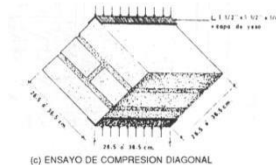
ILUSTRACIÓN 8: Ensayo a la compresión diagonal de adobe
