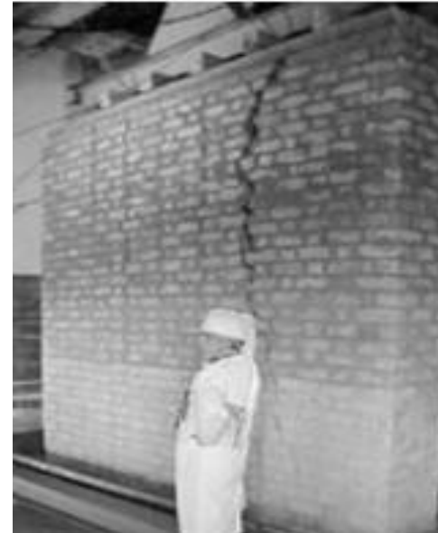
FOTOGRAFÍA 62: Pruebas sobre muros de adobe para observar su comportamiento
